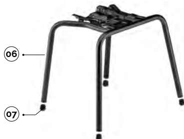
06 rg31-châssis fixe tube ø25 embouts exclus rg31-estructura fija tubular ø25 tapones excluidos
